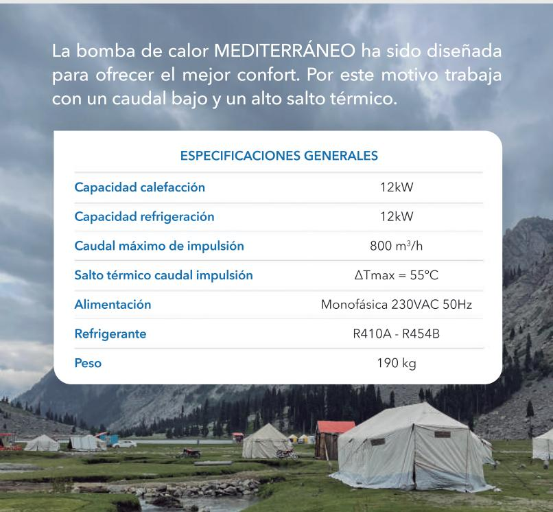
Gracias a la experiencia de MASAM en este tipos de sistemas, MEDITERRÁNEO es la única bomba de calor portátil del mercado que puede trabajar en condiciones climáticas que van desde -5°C, para producción de calor, hasta 55°C, para producción de frío. Además, la renovación del aire es total, ya que permite trabajar con solo aire exterior.
